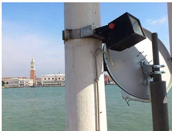
Fig 2.1.12 Ett experiment i Venedig i Italien visade att det går att överföra flera oberoende radio- och TV-kanaler över stora avstånd, utan att öka signalens bandbredd, genom att koda strålningens banimpulsmoment i två olika kvanttillstånd. (Bild: Bo Thidé, IRF)
