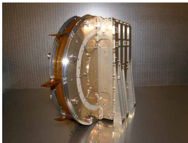
Fig 2.1.6 Flygmodellen av instrumentet ENA för japanska JAXA:s Mercury Magnetospheric Orbiter på BepiColombo-missionen till Merkurius med uppsändning 2014. (Bild: IRF)
