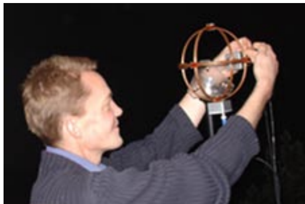
Fig. 2.5.1 Det patenterade treaxiella antennsystem som ingår i det mätinstrument för såväl satellitburna som markbundna mätningar som utvecklats inom programmet.
